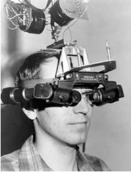
Resim 3.1. Ivan Sutherland tarafından geliştirilen optik görüntüleyici HMD
